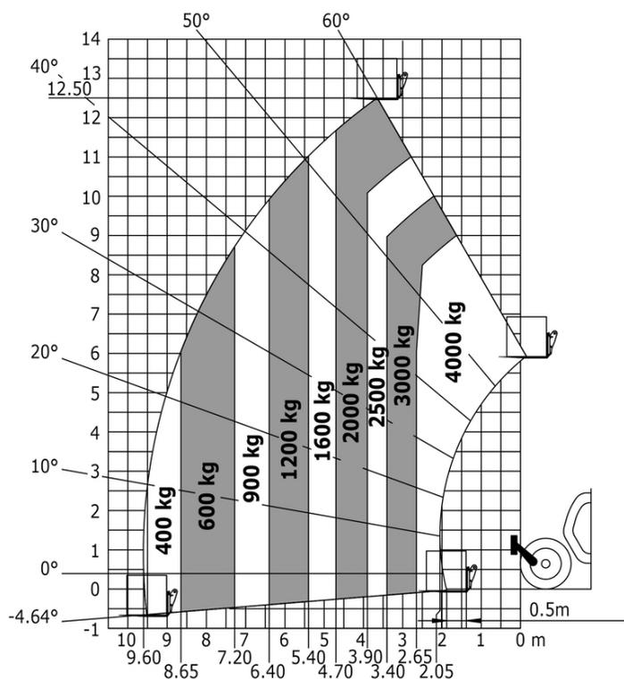
Rotación sobre estabilizadores bajados, con horquillas
